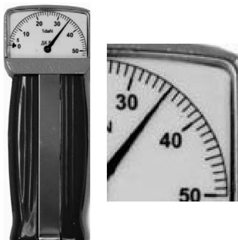
Запишите в ответ показания силомера с учётом погрешности измерений.
